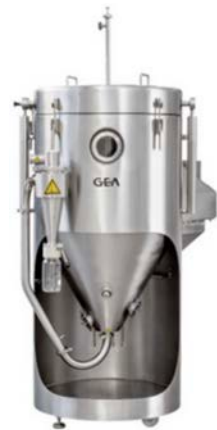
Úðapurrkarinn er sérhannaður fyrir rannsóknir og þróun og getur þurrkað allt að 6 kg/klst af vatni.
