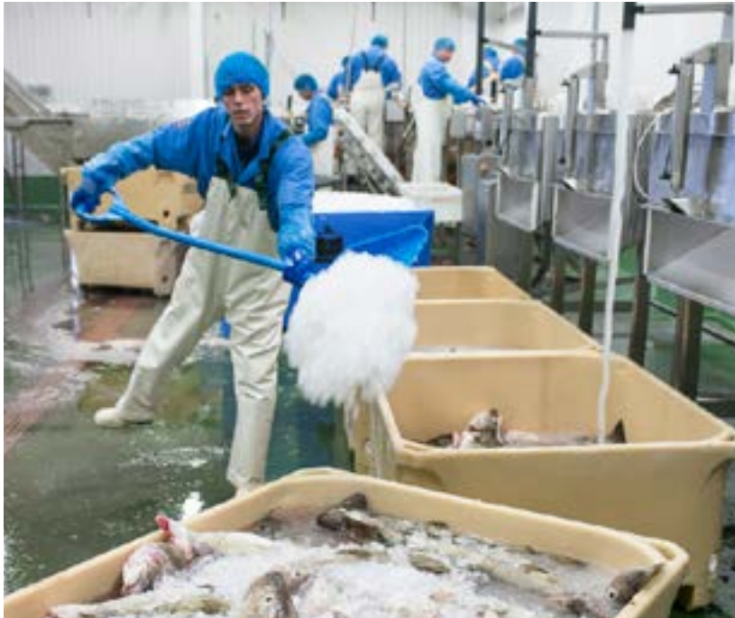
Í móttöku er hráefni slægt, stærðarflokkað og kælt með krapa og ís
