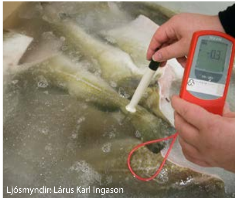
Fylgjast þarf með hitastigi og miða við að hafa það aðeins undir 0°C
