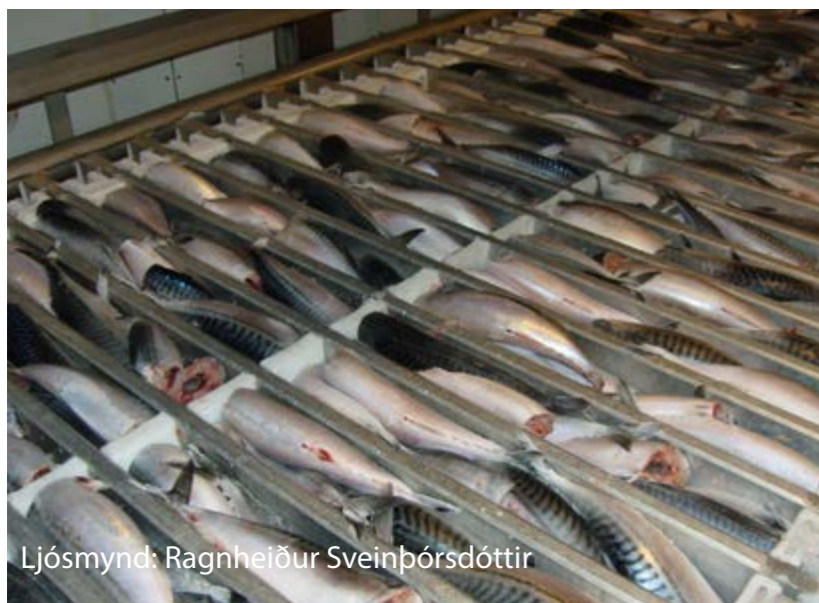
Hausaður og slógdreginn makrill í lóðréttu frystitæki
