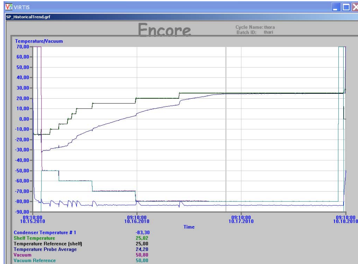
Mynd V1. Þurrkferli fyrir frosthurrkun á sölvum. Stillingar (efri mynd) og breytinga á hitastigi (neðri mynd).
